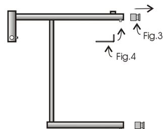
Pegue o Toalheiro (fig.1) encaixe-o na Mão-Francesa (fig.2) e prenda-o com os parafusos Allen.
