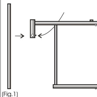
Seguindo as medidas ao lado, sua bancada ficará com 820 mm de altura na parte superior da Bancada. Faça as marcações em seguida Fixe os Suportes de Parede (fig.3) conforme desenho ao lado.
