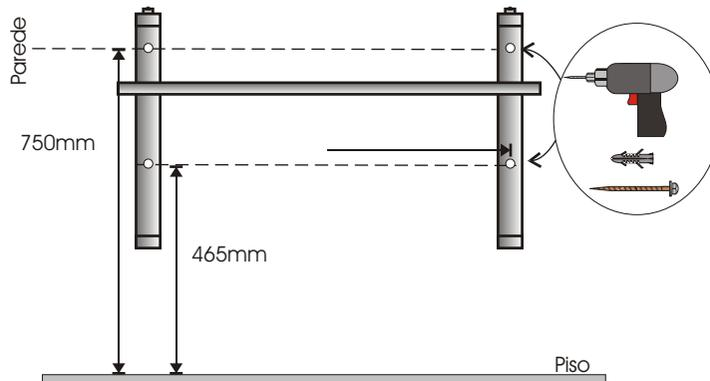
Seguindo as medidas acima, sua bancada ficará com 820 mm de altura na parte superior da Bancada. Fixe na parede as Mãos-Francesas (fig.2) utilizando os Parafusos (fig.3) para prende-las.
